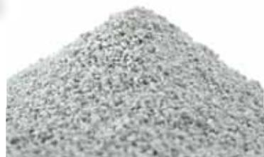
Le Filter AG est un dioxyde de silicium déshydraté utilisé comme moyen filtrant de haute efficacité pour la réduction de matière en suspension. Ses arrêtes fendues et la surface irrégulière procurent une grande surface filtrante, une voie de passage sinueuse garantissant une filtration efficace.
